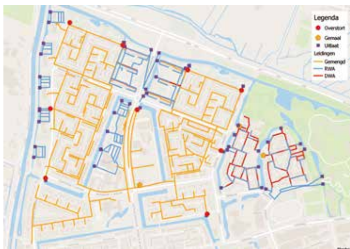
■ Figuur 3: Het studiegebied is een bemalen rioolstelsel in de wijk Overwhere, Purmerend.
